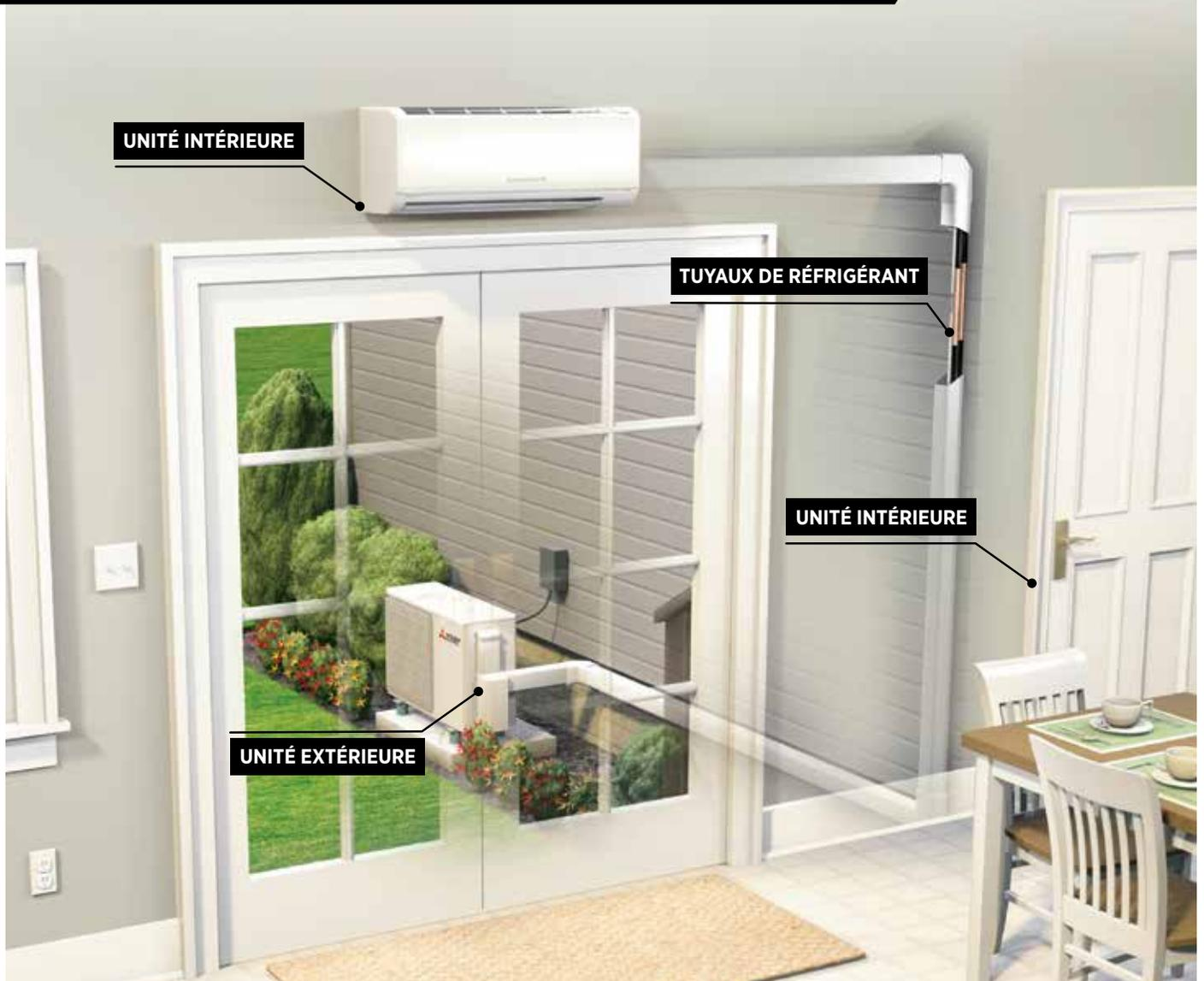
Les systèmes de thermopompes avec ou sans conduits acheminent le réfrigérant chauffé ou refroidi directement vers une unité intérieure par de petits conduits. Chaque espace de vie possède sa propre unité de traitement d'air, et chaque unité dispose de son propre contrôle électronique de température sans fil. Voici comment le système fonctionne dans une application pour une seule pièce.
